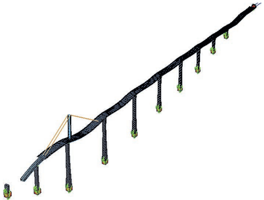
Bild 23. Gesamtmodell Montage/Verschub (verschobener Zustand) Fig. 23. Visualisation of the overall model-assembly/sliding (state after sliding)
